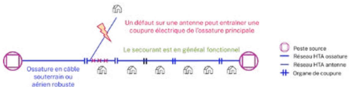
Figure 34 : le traitement des antennes à risque climatique avéré
