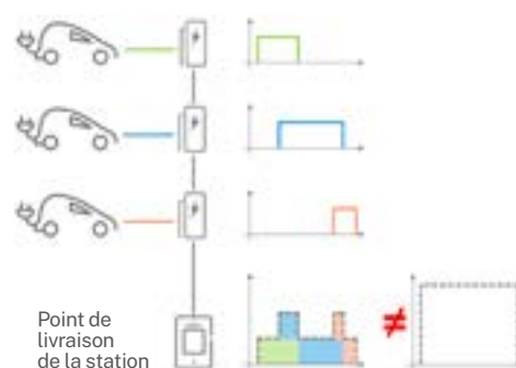
Figure 13 : répartition de la puissance appelée par trois points de charge
