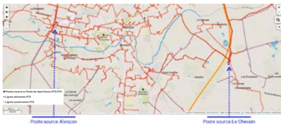
Figure 47 : une visualisation du réseau HTA, aérien et souterrain, qui alimente la zone d'Alençon
